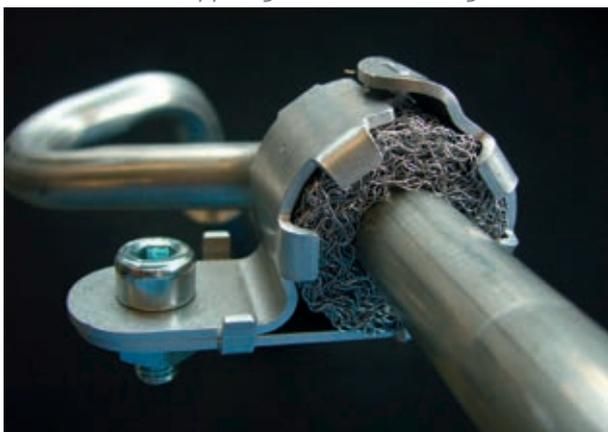
Entkopplungsglied zwischen Abgasleitung und Motor
